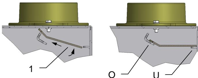
Stahlumlenkplatte (1) wie abgebildet in den Brennraum einfahren und auf den oberen (O) und hinteren (U) Auflagewinkel ablegen.
