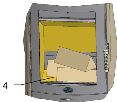
Der Abbrand einer Brennstoffmenge (4) von 2,0 bis 2,2 kg (entspricht ca.3 Stk. Holzsplit) dauert je nach Brennstoffqualität, Schornstein- und Witterungsbedingungen ca. 40 bis 45 Minuten. Nach Abbrand und Erreichen der Grundglut kann eine neue Brennstoffmenge aufgelegt werden.
