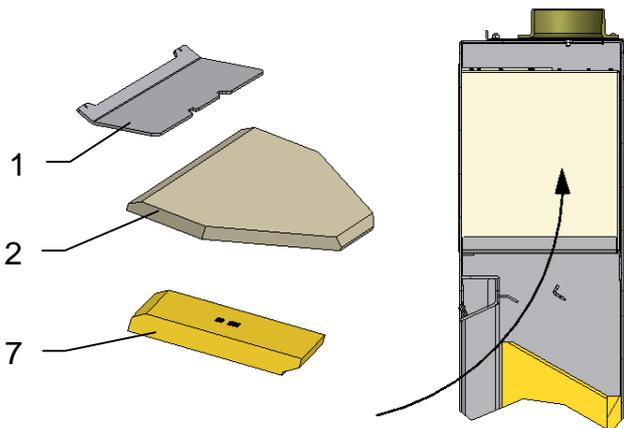
Zum Reinigen der Ofenrohre können die Umlenkplatten (1) und (2), sowie die Deckelplatte (7) entfernt werden.
