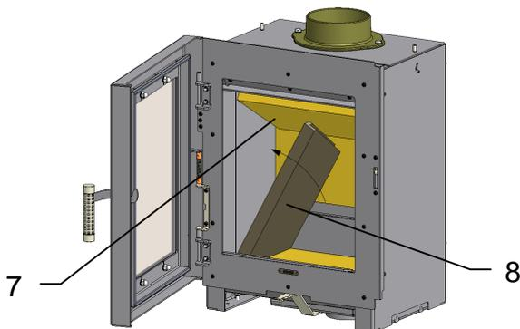
Linken Seitenstein (8) mit Schräge zum Rückwandstein einsetzen und an die Brennraumseitenwand schieben. Dabei die Deckelplatte (7) etwas anheben und in den Falz des linken Seitensteines (8) legen.
