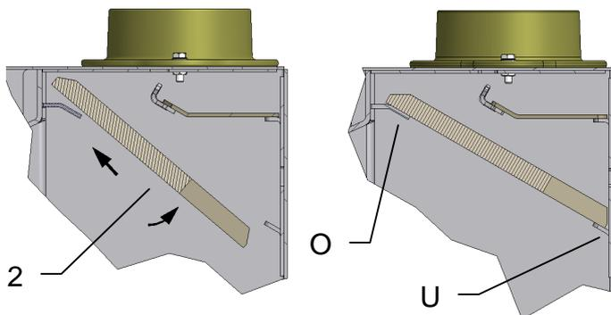
Umlenkplatte (2) wie abgebildet in den Brennraum einfahren und auf den oberen (O) und hinteren (U) Auflagewinkel ablegen.
