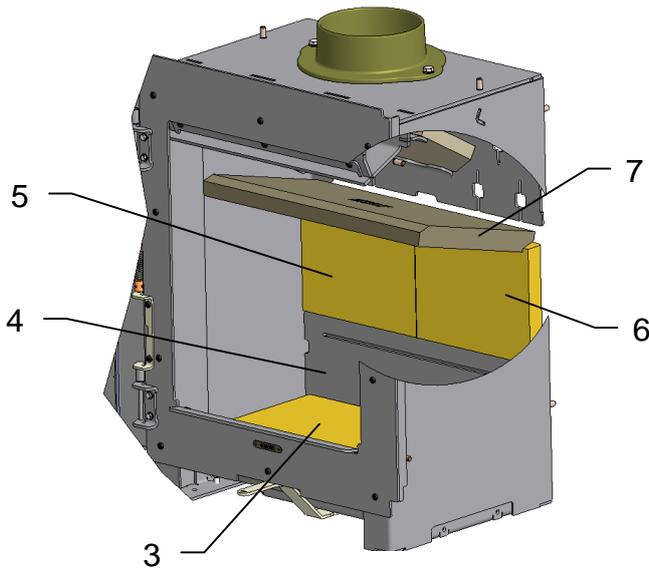
Primärluftleiste (4) hinter der Bodenplatte (3) in den Brennraum stellen und ausmitteln.
